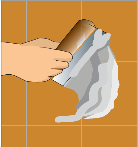
Рис. 10.39. Заполняем отверстия и трещины на стене шпаклевочным раствором, поверхность выравниваем
