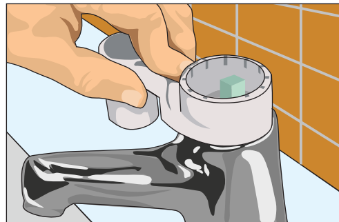
Рис. 11.30. Отворачиваем накидную гайку
