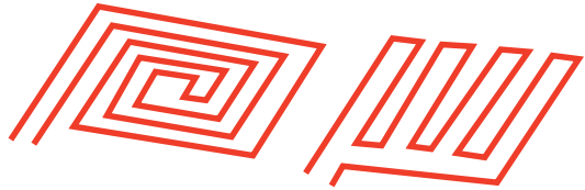
Рис. 12.9. Спиральный (слева) и параллельный (справа) варианты укладки теплого пола
