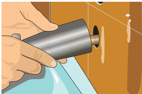
Рис. 10.185. Устанавливаем смеситель (слева) и душ (справа)
