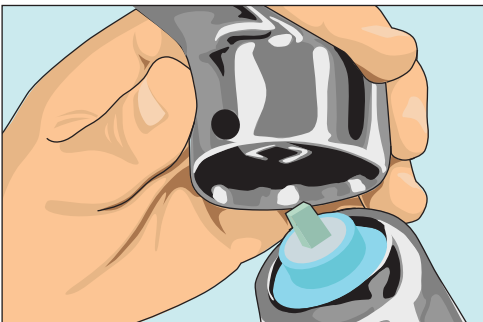
Рис. 11.29. Снимаем ручку смесителя
