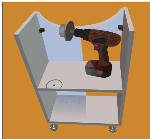
Рис. 10.60. Просверливаем отверстия под сифон и подводящие шланги воды (если они не были предусмотрены заранее)
