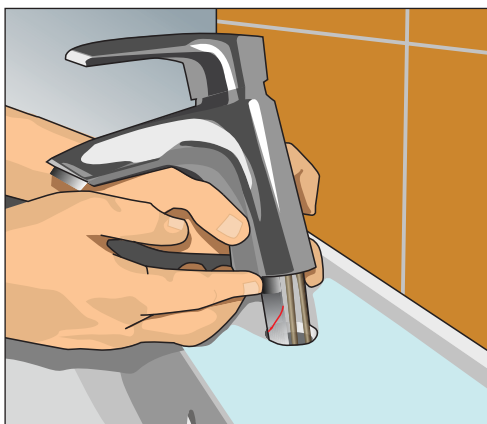
Рис. 10.28. Ставим смеситель в предназначенное отверстие умывальника
