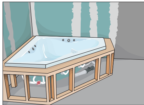
Рис. 10.191. Установка джакузи в деревянный каркас
