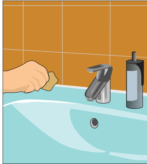
Рис. 10.50. Проверем соединения на герметичность, промежуток между стеной и раковиной заполняем силиконовым герметиком
