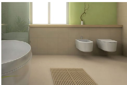
Рис. 9.3. Расстояние между биде и унитазом должно составлять не менее 25 см
