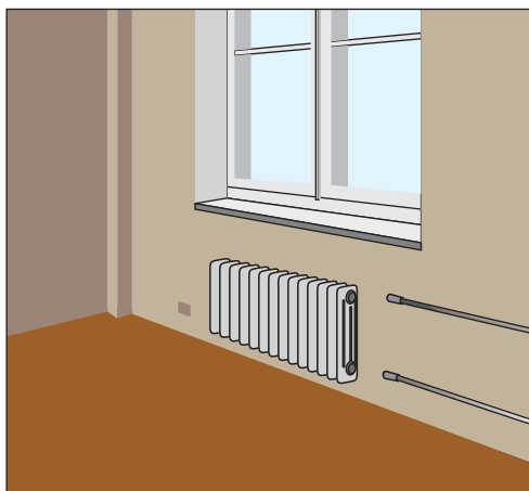
Рис. 12.59. При правильном монтаже радиатор жестко опирается на все 4 опоры
