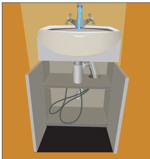
Рис. 10.61. Устанавливаем на тумбу умывальник, для этого можно применить жидкие гвозди
