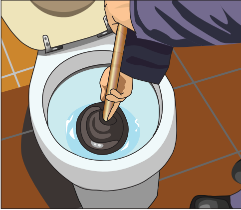
Рис. 11.14. Продолжаем качать воздух до тех пор, пока вода не станет проходить
