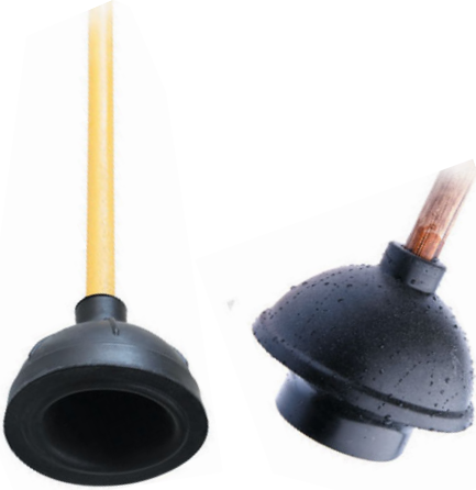
Рис. 11.3. Вантуз для раковины (слева) и унитаза (справа)
